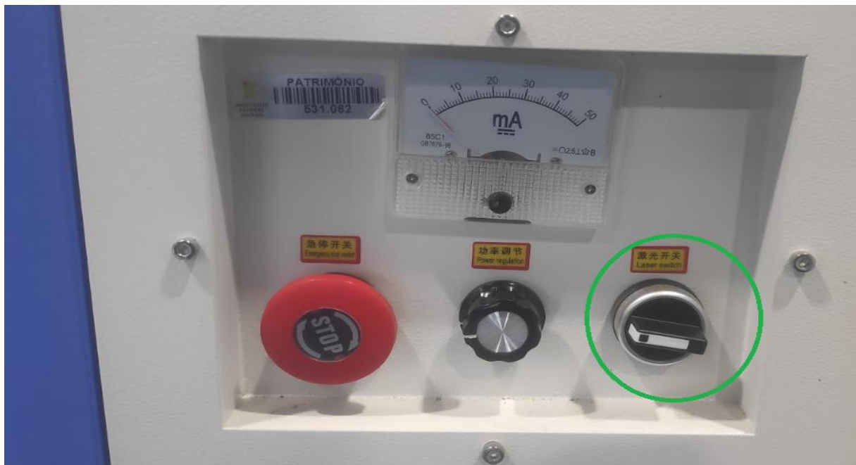
Figura 60 - Chave Socket switch. (Liga periféricos do equipamento)
