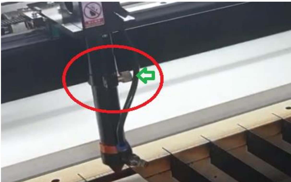
Figura 23 - Trava de fixação vertical do laser.
