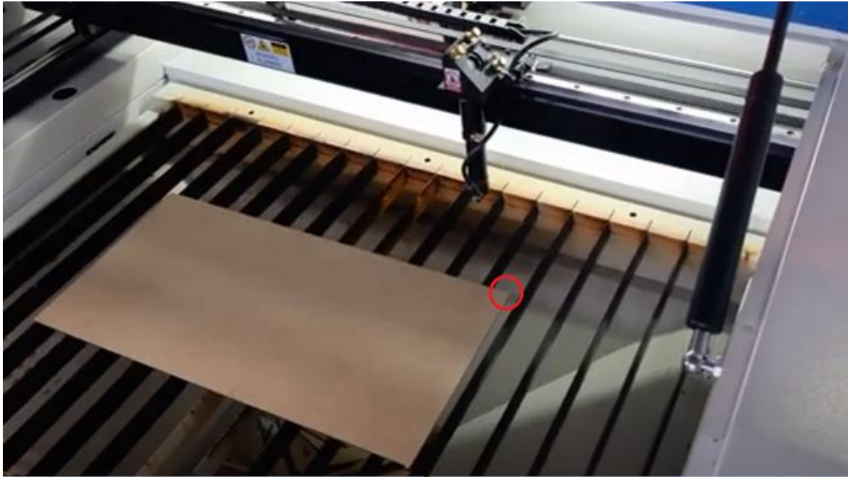
Figura 55 - Local apropriado para estabelecer como origem absoluta.
