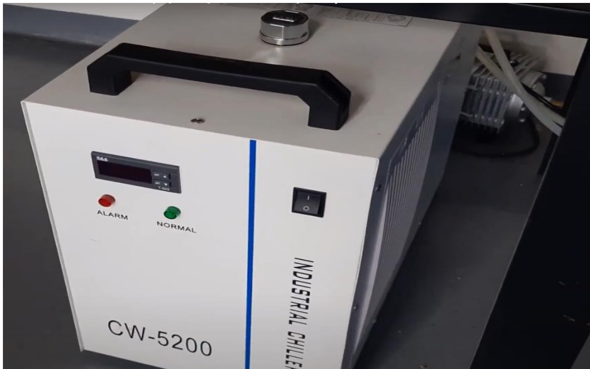
Figura 8 - Periférico de refrigeração de água
