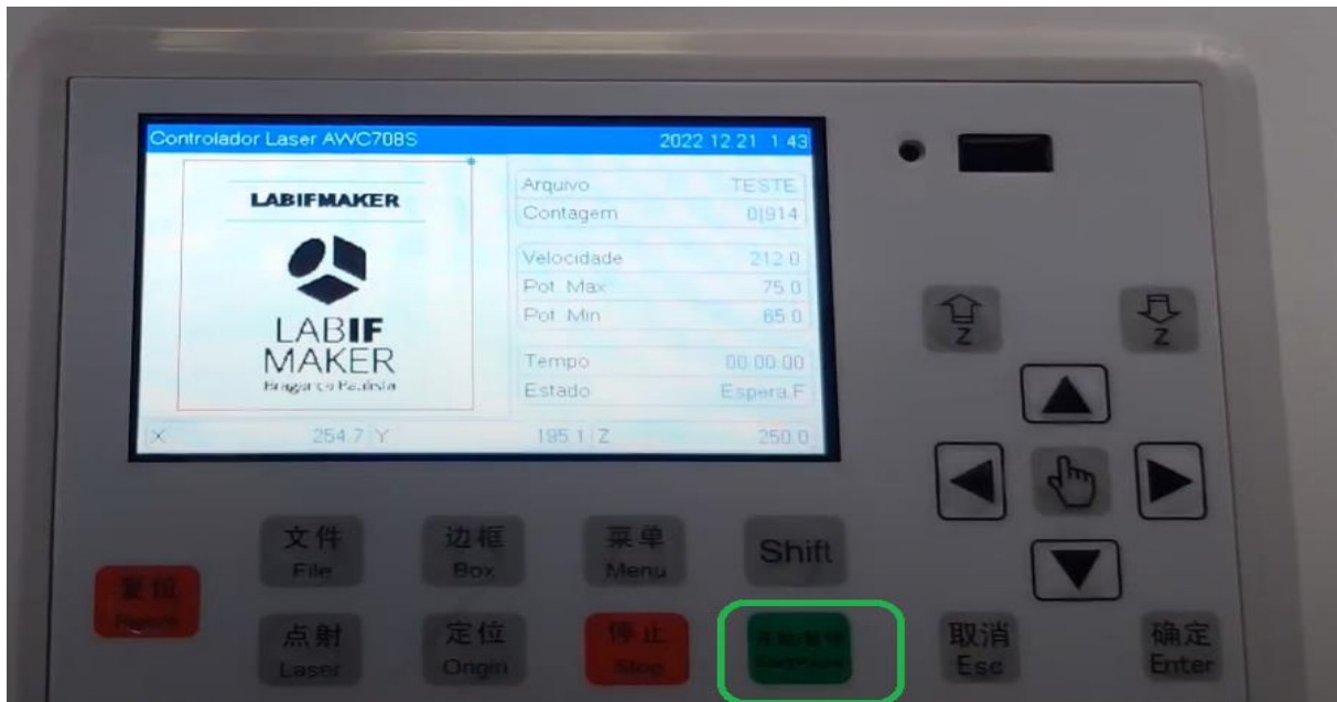
Figura 61 - Chave Socket switch. (Liga periféricos do equipamento)
